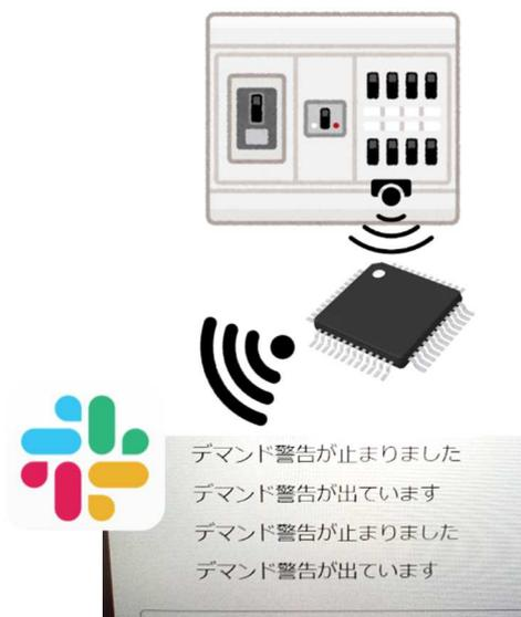
夏場に冷房・冬場に暖房をつけるなどして規定量の電気を消費するとデマンド警告が鳴ります。デマンド計の近くの人達はそれに気づき対応しますが、そうでない人はその状況に気づかず節電の対応をしないため、デマンド警告が鳴りっぱなしといったことがありました。そこでデマンド計にセンサーを取り付け、デマンド警告が鳴った時に社内コミュニケーションツールである Slack に通知が行くようにし、全員がデマンド警告に気づけるようになりました。その結果、警告が鳴ったら近くの電気や空調設備を消すなど、現場で働く人たちの意識が向上し、節電行動に繋がるようになりました。
